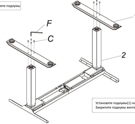
Установите подиумы(1) на нижнюю часть подъемной стойки(2). Закрепите подиумы винтами(C) с помощью шестигранного ключа(F).
