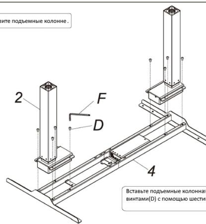
Вставьте подъемные колонны(2) в концы опорной балки(4). Закрепите колонны винтами(D) с помощью шестигранного ключа(F).
