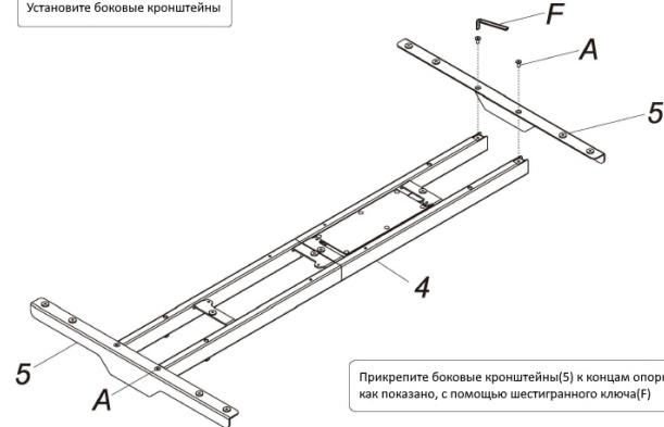
Прикрепите боковые кронштейны(5) к концам опорной балки(4) с помощью винтов(A), как показано, с помощью шестигранного ключа(F).
